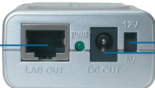
**LAN OUT:** подключите прямой кабель категории 5 RJ-45 к устройству Ethernet.
